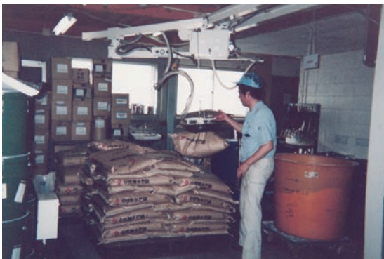
ロープスライドタイプ ●天井の低い所で使えます。 Rope Slide type ●You can use at low ceiling.
